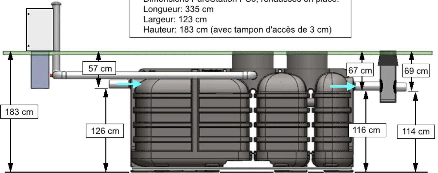
Dimensions PureStation PS6, rehausses démontées:
